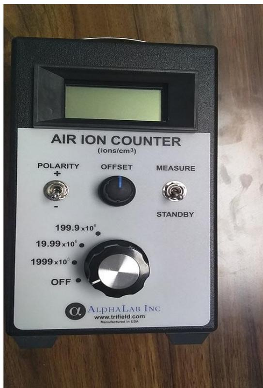
AIC200M/3000 负离子测试仪是吸引空气(或者带有离子存在的气体)通过带电的平行极化电极板进行计数空气中的正、负离子(气体)浓度的, 外侧二板保持极化(正、负)电势。中间是线性检测器板。空气的孔隙是 4MM, 极化区的电势是 1000V/M。既可测量正离子, 又可测量负离子。广泛应用在负离子发生器制造行业, 如负离子空调、负离子发生器、负离子电吹风、负离子涂料、负离子灯具等等以及可有关机体的负离子浓度的测量, 如环境、固体物质(石头和灰)、布匹、纤维等。
