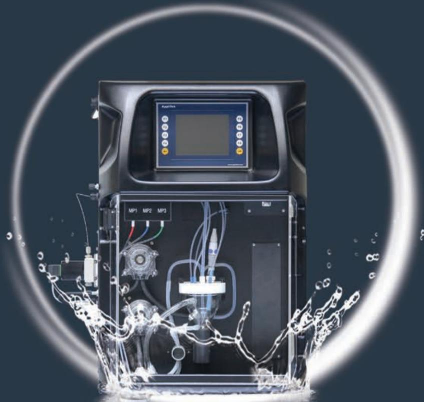
AppliTrace®在线重金属分析仪是一台采用电化学阳极溶出伏安法的分析仪器，用于测定痕量金属（砷、镉、铬、铜、铁、铅、汞、镍、铊、锑和锌等近17种重金属）。对于每个应用程序和不同的测量范围，AppliTrace®会选择最合适的方法。
