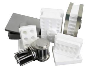
用于细胞破碎的微孔管适配器
