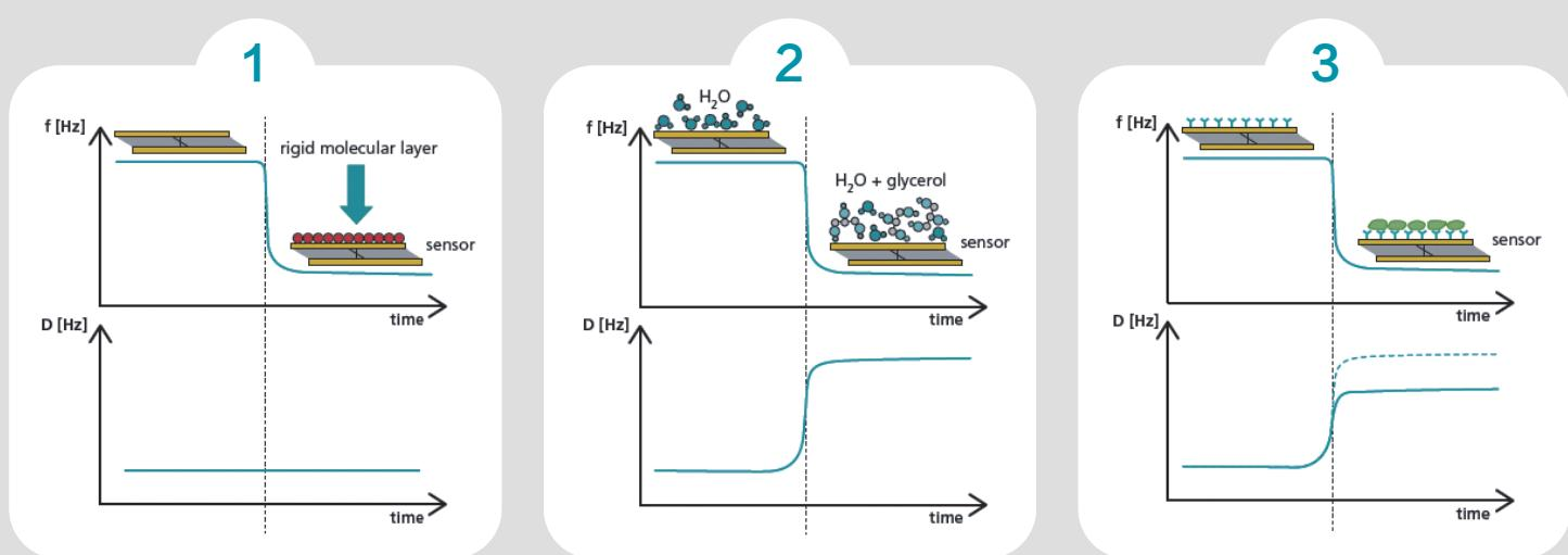
上图分别显示了三种不同性质物质在芯片表面反应时频率和耗散的变化：
