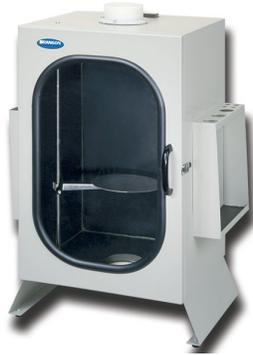
**隔音箱：**20 kHz 的超声波在人的听觉范围之外，但无法避免气穴现象所造成的噪音，在隔音箱内使用 Sonifier SFX 系列可以最大程度降低这种噪音。其机身坚固，内衬防水材质且吸音，能防止大多数溶液或者试剂的渗透，也容易清洁。全透明门可方便您查看处理过程，同时又可以将高频噪音降低 25-28 db，适合实验室长时间，大量的处理。
