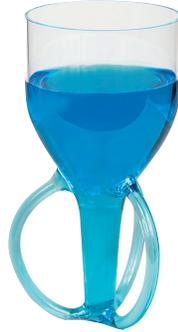
**莲花冷却杯：**必能信的莲花冷却杯提供独特的冷却模式，使样本在杯内循环时完全暴露在超声波的能量中。当杯体浸入到冷却槽中时放大的玻璃表面积和可循环的侧壁提供了有效的热交换方式，有效降低样本温度。
