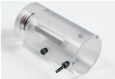
**杯式探头：**此专业杯式探头，不与样本直接接触，通过液体将超声波能量传输至样本中，防止样本的交叉污染。仅限 3.0" 直径。
