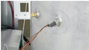
罐体上标准配备2处传感器接口。 可选购记录仪和高性能的压力计。
