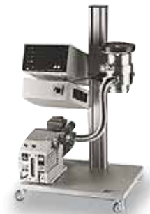
真空泵工作站的最终压力可达10 -5 mbar
