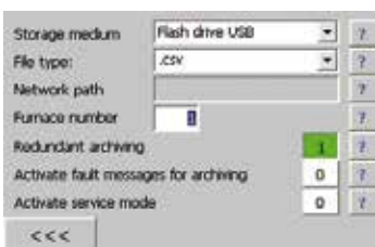
NTLog Basic 用于供纳博热控制器来记录数据
