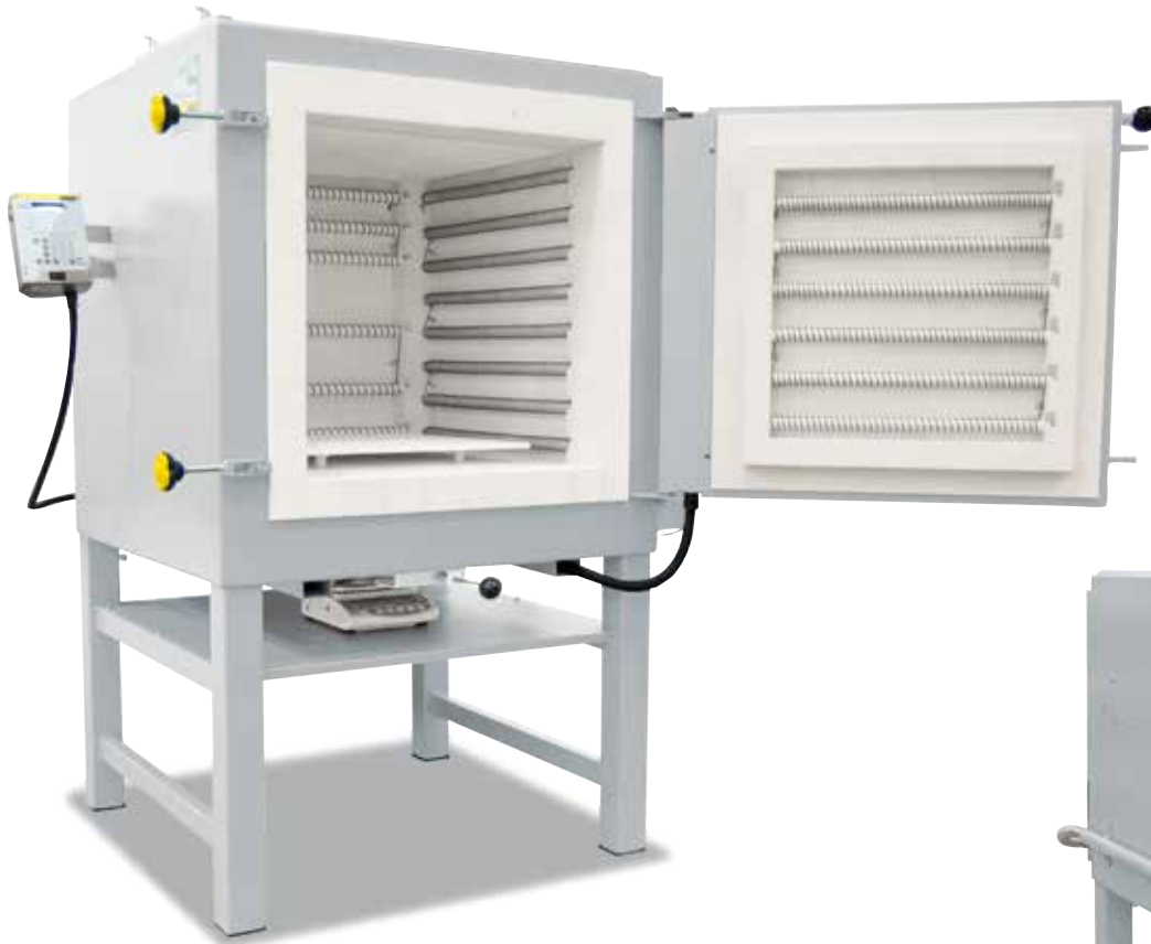
LH 216/12SW 带燃烧失重称量装置
