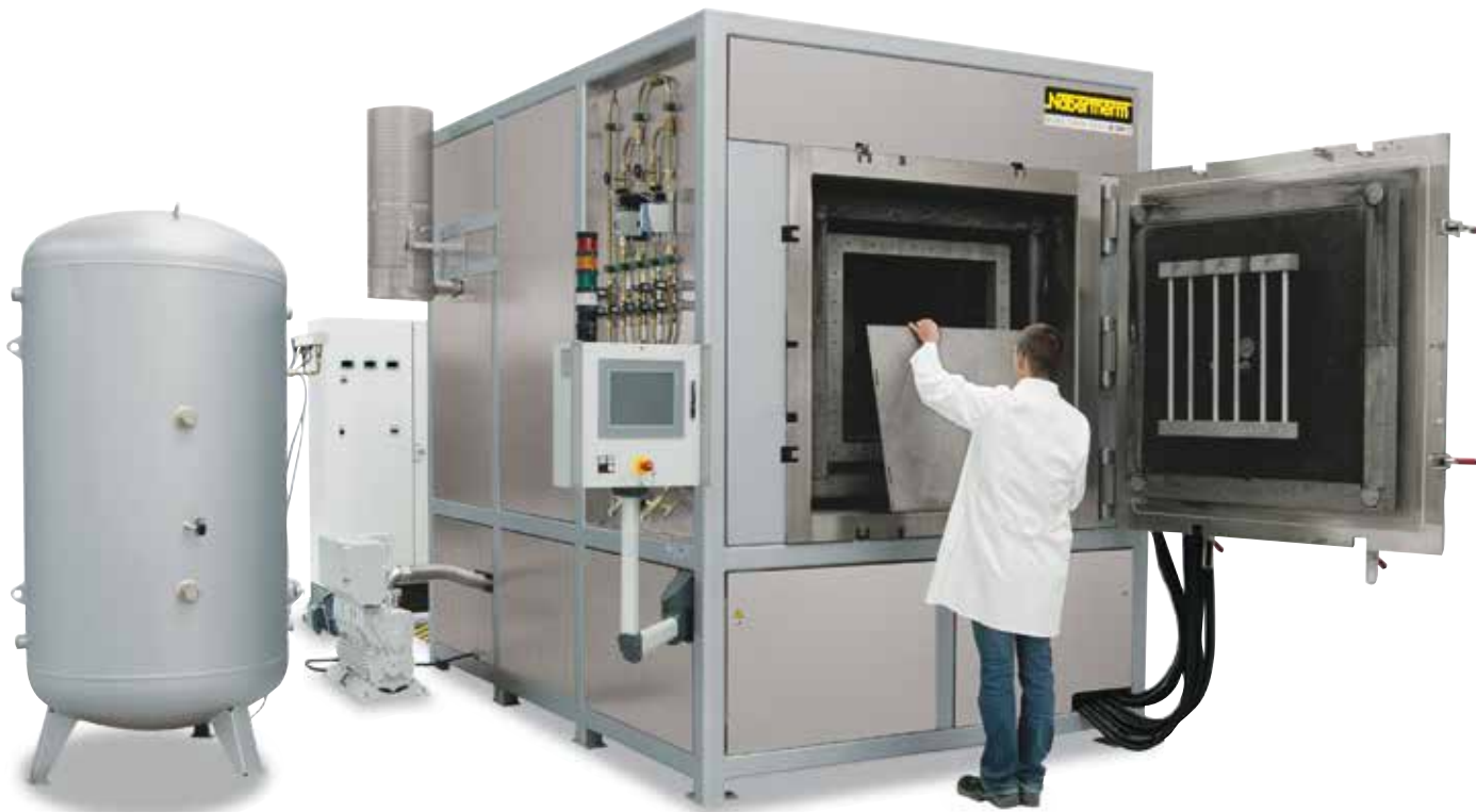
VHT 500/22-GR H 2 连同扩展包和CFC 工艺盒，用于氢气环境下的操作
