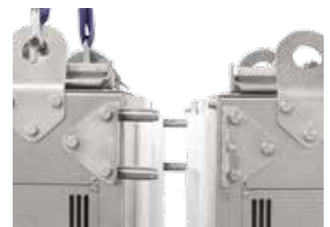
用于连接两半炉体的铰链螺栓
