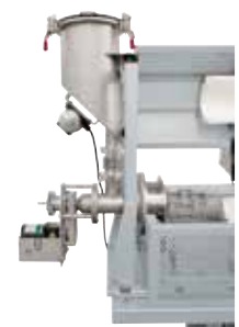
装填漏斗处装有振动发生器，用于更好地粉末导入
