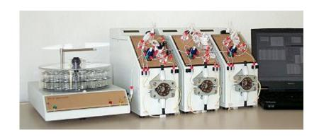
FIA 集成式仪器适用于分析参数的顺序测量。方法更换简单易行。有通用方法单元(水质分析的基本参数测量:  $NH_4$ ,  $NO_2$ ,  $NO_3$ ,  $o-PO_4$ )供用户选择。FIA 集成式主机有 2 个独立的多通道蠕动泵,可实现复杂的样品前处理,如样品的消解,富集和高灵敏度渗析等。
