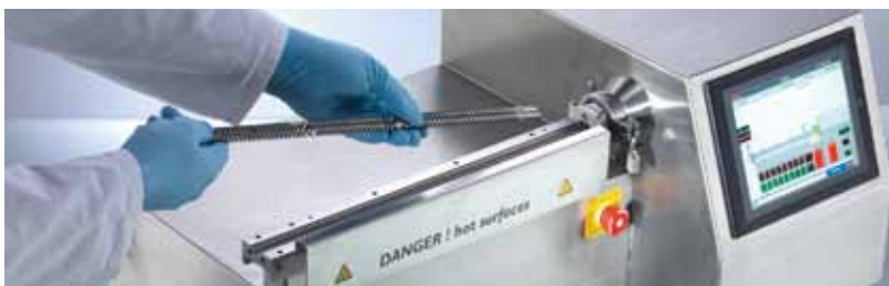
可拆卸式上半部机筒，蛤壳形机筒设计，方便清洗
