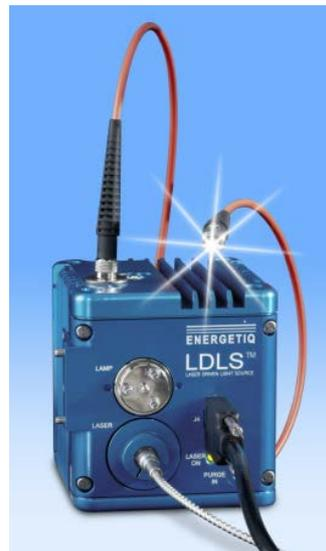
Energetiq 公司开发的宽带白光光源，采用激光泵浦的方式维持等离子体放电发光，避免了使用电极所带来的种种缺陷。首先通过高压放电点燃灯泡内的氙气，使氙气温度升高电离变成等离子体，连续激光光束经过透镜聚焦进入灯泡，利用激光的能量来维持灯泡内的等离子体，此时高压即可关闭，采用聚焦良好的激光来维持等离子体，可以使紫外光激发稳定而且易于聚焦。LDLS 的等离子体被束缚在一个很小的球状区域内，密度大大增加，发光亮度也大幅度提高；由于 LDLS 等离子体中心位置高度稳定，空间稳定性也变得很好。这种接近于点光源的设计使 LDLS 在较长距离都有很好的准直性。此外 LDLS 等离子体不与电极直接接触，电极并未受到侵蚀，增加了使用寿命。
