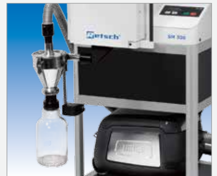
可选用旋风分离器组合套件，对样品起到冷却作用 (SM200及SM300)
