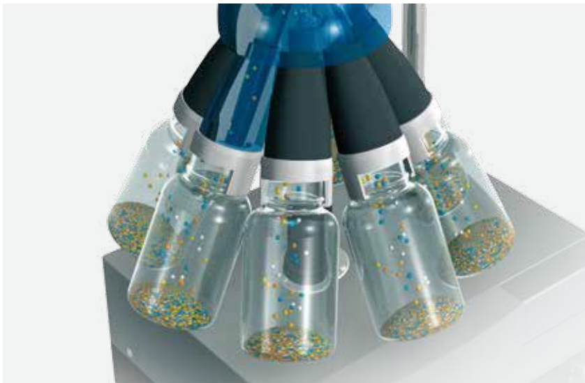
块状材料：小颗粒会向底部聚集，从上部采集的样品并不具有代表性。
