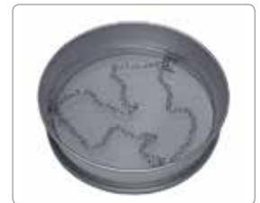
RETSCHE提供辅助链环，玛瑙、滑石和橡胶球，刷子和聚氨酯助筛块
