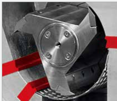
三块平行刀片组装成的平行转刀，最佳切割效果 (SM200及SM300)
