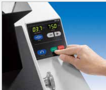
数显颚板间隙宽度和速度
