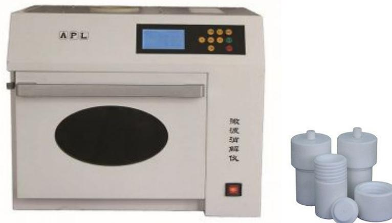
1988 年罗方若教授带领其研究生对“微波辅助样品制备”的应用进行研究并自主设计研发其核心部件：FR-1（方若 1 号）有自动安全装置的密封增压的样品消解罐，并广泛应用在原子光谱分析中前处理，1993 年 FR-1 型有自动安全装置的密封增压的样品消解罐申请并获得国家专利支持，随后将产品推向全国。2003 年具有双重安全防爆的 FR-2 型微波消解罐获得国家专利。
