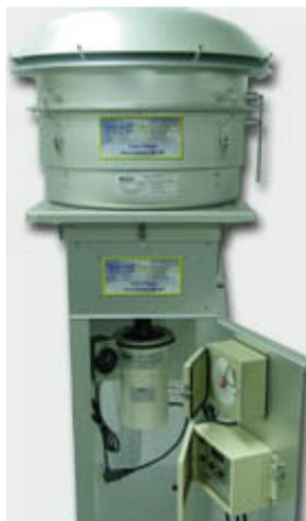
系统组成：PM10 切割头，铝制气泵，具有停滞压力孔 8" x 10" 不锈钢过滤器支架，体积流量控制器（VFC），30" 水柱压力计，七天机械计时器，连续流量/压力记录器，滤筒/滤纸卡套，电源（220V/50Hz）
