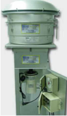
系统组成: PM10 切割头, 铝制气泵, 具有停滞压力孔 8" x 10" 不锈钢过滤器支架, 体积流量控制器 (VFC), 带数字式时间指示器的数字式定时器, 30"水柱压力计, 连续流量/压力记录器, 滤筒/滤纸卡套, 电源 (220V/50Hz)
