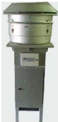
系统组成: PM10 切割头, 铝制气泵, 具有停滞压力孔 8" x 10" 不锈钢过滤器支架, 体积流量控制器 (VFC), 30" 水柱压力计, 七天机械计时器, 带 20/60 scfm 流量探头的质量流量控制器, 连续流量/压力记录器, 滤筒/滤纸卡套, 电源 (220V/50Hz)
