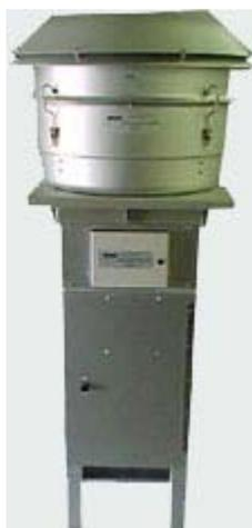
质量流量控制可吸入颗粒物系统组成：PM10 切割头，铝制气泵，具有停滞压力孔 8" x 10" 不锈钢过滤器支架，带 20/60 scfm 流量探头的质量流量控制器，带数字式时间指示器的数字式定时器，30" 水柱压力计，连续流量/压力记录器，滤筒/滤纸卡套，电源（220V/50Hz）
