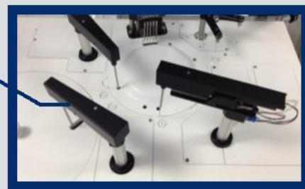
3个自动机械臂, 1个取样, 2个取试剂
