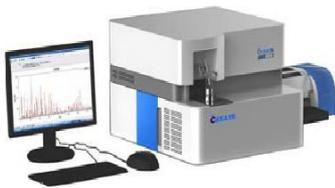
一、 CX-9800 直读光谱仪凭借其高性能及可靠设计，以及创新光学系统和扩展的波长范围，可确保对重要元素的精确鉴定和痕量分析，仪器拥有极低的检出限及优异的长期稳定性；分析结果准确，重现性好。中测仪器运用领先的CCD检测器与数字读出技术相结合，使仪器整体设计优于传统的光电倍增管技术，已逐渐成为金属制造业，加工业及铸造业的首选。
