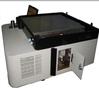
三、 **CX-9800** 光谱仪采用了全新的真空光室系统设计，与传统的氩气吹扫系统相 比，其优势是巨大的。首先在仪器非工作状态下不需要实时的对光室进行氩气 吹扫，大大降低了氩气的使用量，节约了客户的使用成本。 其次中测 仪器的真 空 光学系统保证了仪器在冷启动(关 机重启)状态 下
