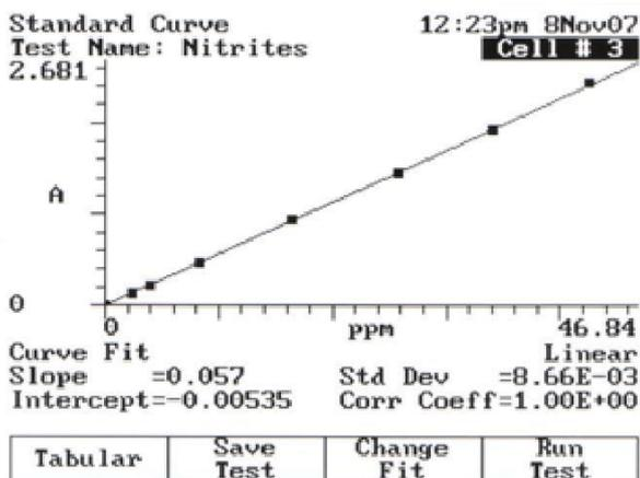
标准曲线显示屏可以帮助轻松建立浓度测试方法。共有7条曲线、15个标准和10个预先设定好的测试方法供选择，也可自行创建。
