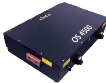
信号光（1.38 – 2.00  $\mu\text{m}$ ）和闲置光（2.28–4.67  $\mu\text{m}$ ）辐射是通过在单晶体上整合多个极化周期而实现的。系统任意所需的发射频率的调谐都无需更改光学组件。调谐可以在以下几个层次上进行：
