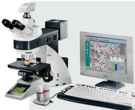
此仪器适于磷灰石\锆石等裂变径迹的研究,裂变径迹技术可研究矿区内主要断裂带构造活动的发生时间和构造活动期次,建立构造年代学时空格局;研究构造热事件活动历史,查明相关地区在不同时间的热状态,计算相关地区的隆升速率、隆升强度和矿区的剥蚀程度,掌握构造控矿规律,提高量化研究程度,为找矿预测提供依据。主要借助于 leica 科研级正立全自动智能数字偏光显微镜。
