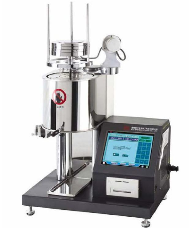
设备概述： 熔体流动速率试验机（亦称熔融指数仪）是测定热塑性塑料在一定条件下的熔体流动速
