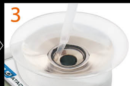
3 将纯净水倒至附属装置的基准线或者用移液器将样品稀释 50 倍至 10ml (加水 9.8ml)，并搅拌均匀。
