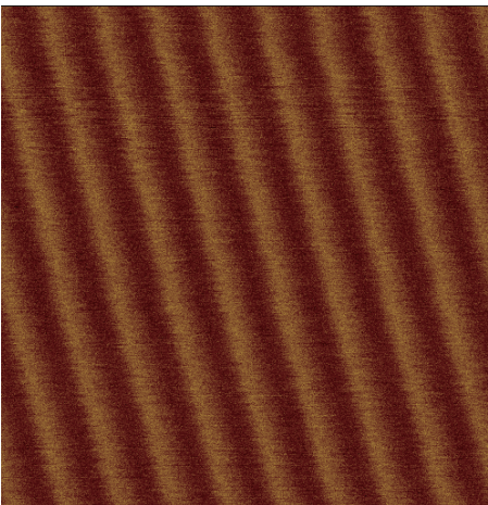
图 4 AAC 模式对正烷烃进行高分辨成像（左图：C18H38，扫描范围 20nm，中图：C36H74，扫描范围 350nm，右图：正烷烃在石墨基体上的分子排列示意图）
