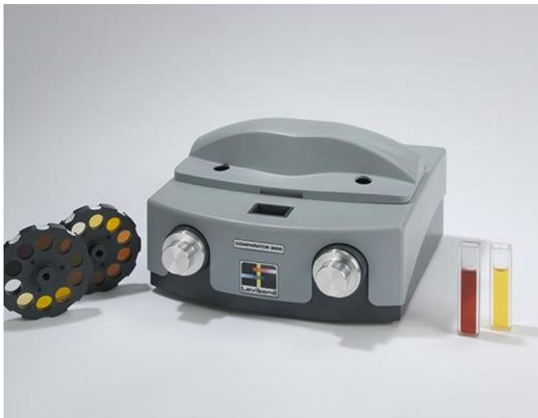
AF650是三视场目视比色仪，通过与左右两个标准比色盘的颜色直接比色来获得样品的ASTM色度值。仪器可以对样品和两个比色盘同时进行观测，使用户更容易找到最匹配的色度。卤素钨灯符合CIE标准C光源，保证在色度测定中，无论是白天还是夜晚，均保持恒定的光源条件，不受外界环境的影响。
