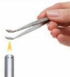
将镊子在打火机的火焰中来回翻面移动进行灭菌，并冷却
