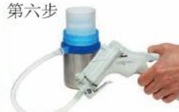
将水样倒入过滤漏斗中至一百毫升刻度线。
