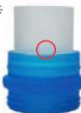
将过滤漏斗向下插入蓝色橡胶基座中到底，
