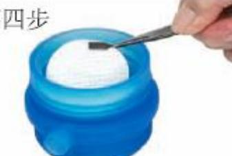
将滤膜直接放在铜质过滤器支架上，
