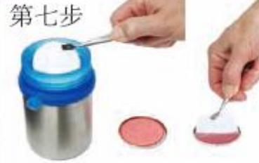
当所有水全部过滤后，断开真空泵连接，
