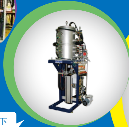
20区布里奇曼设备, 2台炉子之间带可调节温度梯度
