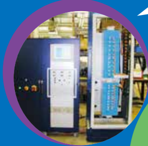
20区布里奇曼设备, 2台炉子之间带可调节温度梯度
