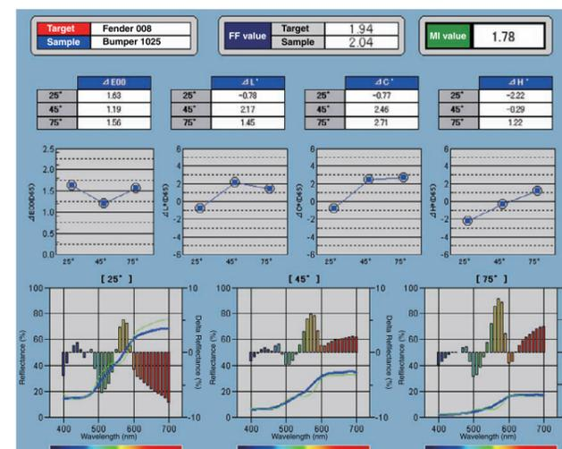
SpectraMagic™ NX（可选配件）是CM-512m3A用于色彩质量管理的理想伴侣。同时显示三个照明角度的测量数据，用图表直观显示每个角度的特性，和创建多个角度的测量结果特性分析。
