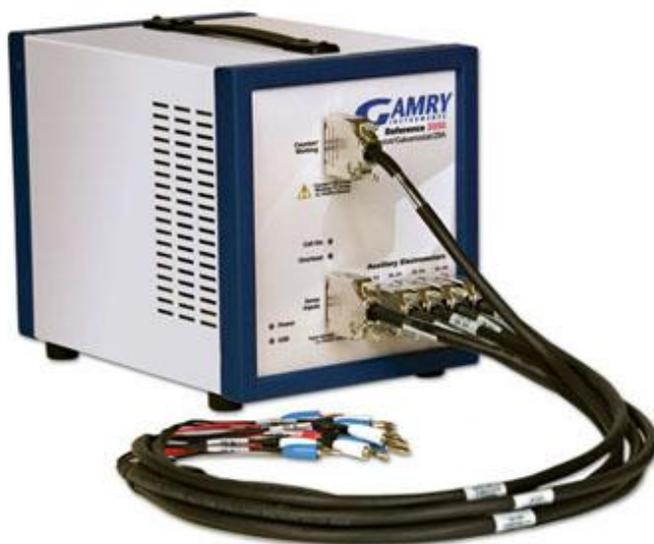
Reference 3000 电化学工作站是美国 Gamry 公司最新型号电化学工作站, 保留了以往型号所有的优势; 卓越的低阻抗测试特性, 准确度到达微欧数量级。为能源材料研究特别改进了硬件和软件, 电流量程 3pA-3A, 可以扩展到 30A, 电压最高 32V, 300K 的采样速度, 电浮动浮地技术; 特别为电池, 电容器, 液流电池等能源材料设计的 PWR800 软件测试包等等。可以进行系列电化学测试编程。同时可以扩展位双恒电化学工作站和 IMPS/IMVS 系统。
