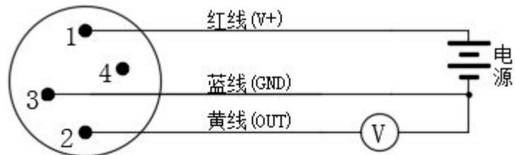
电压输出接线图（三线制）
