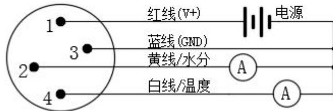
电流输出(带温度)接线图（四线制）
