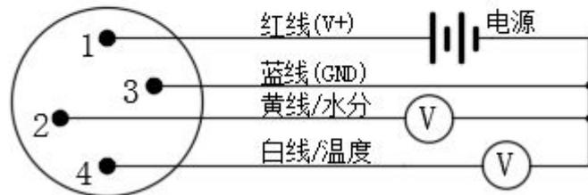
电压输出(带温度)接线图（四线制）
