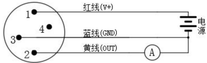
电流输出接线图（三线制）
