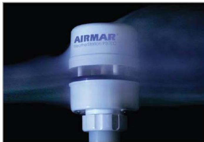
所有的AIRMAR气象站的风速测量都在风洞中经过测试，符合NIST标准。
