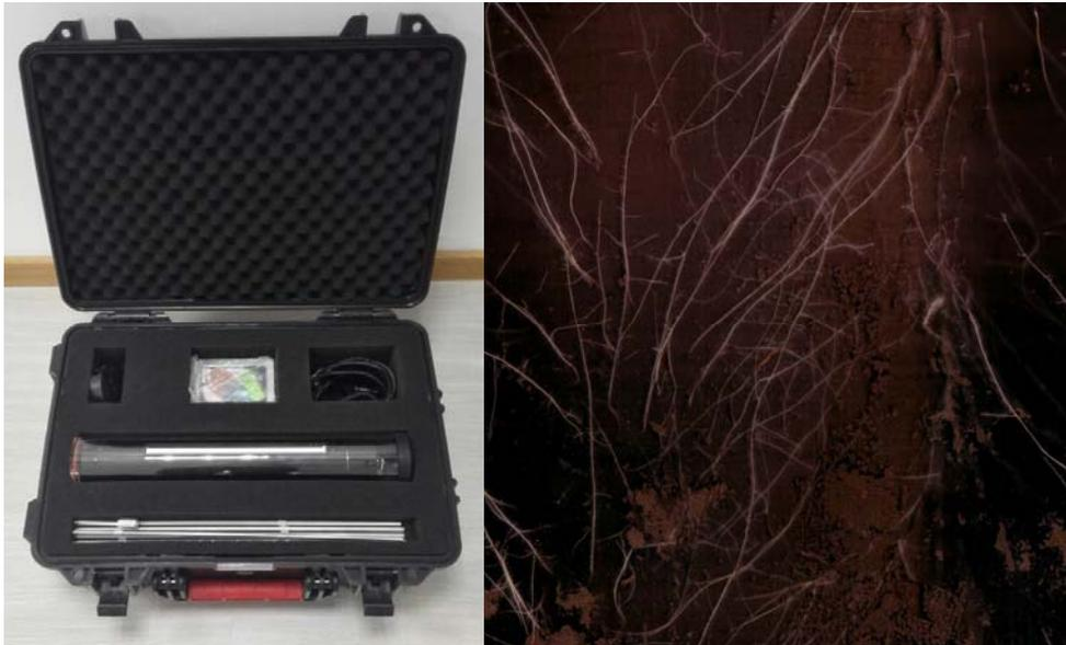
植物根系承担着吸收水分和养分的重要功能，对植物根系的研究一直是学者们的研究热点。但是，由于根系生长在地下，一旦离开土壤必然造成根系损失，这是当前学者们对根系开展研究面临的障碍。根系原位监测系统是经典根系研究方法的重要突破，也是开展长期生态定位研究的理想方法。根系原位监测系统能够在自然状态下，获得植物根系的动态信息，为研究者提供可信赖的研究资料。进而，为科学研究提供更加精确的数据支持，推动科研项目的顺利展开。
