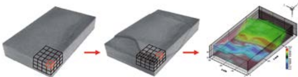
用数字图像相关 (DVC) 方法对3D X-射线断层扫描模拟试验结果进行层析应变分析。图片由伦敦大学皇家霍洛威学院地球科学系J. Adam博士友情提供
