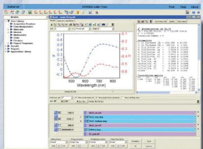
DeltaPsi2是一个完整的光谱型椭圆偏振测量软件平台。它包括先进的测量和分析能力及完整的材料数据库。
