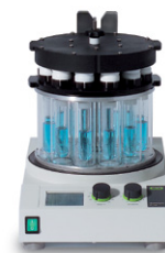
Multivapor™ P-6 / P-12 高效的多样品蒸发仪
