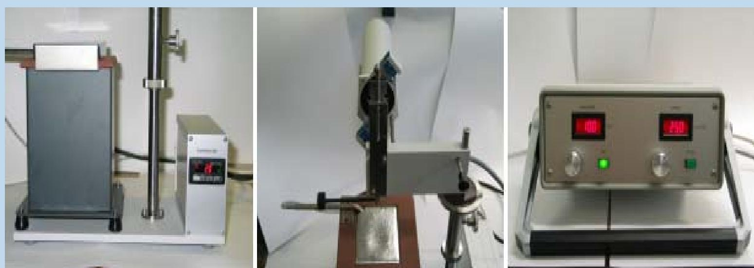
检测DIN 32506规定的金属可焊性
