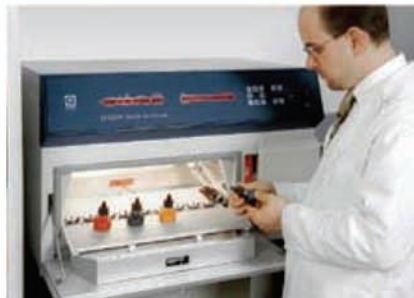
Q-Sun独特的可滑出式样品盘可方便放置零部件、瓶子、试管和培养皿等。
