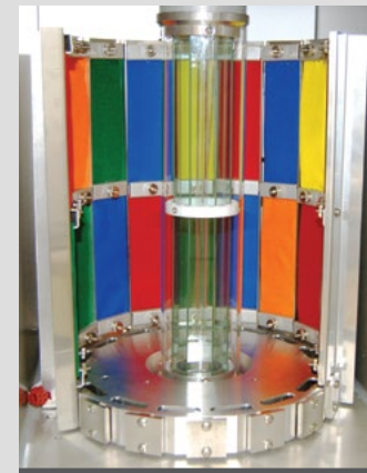
Xe-2试验箱的旋转样品架
