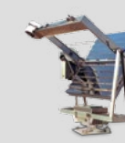
Q-TRAC 太阳跟踪聚能曝 晒测试
