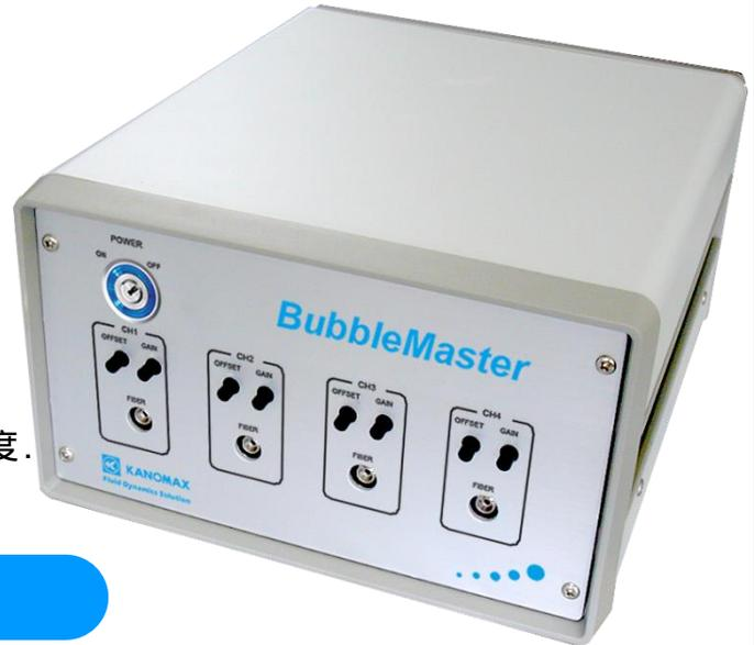
当气泡穿过切角光纤尖端时,反射光强会发生变化
