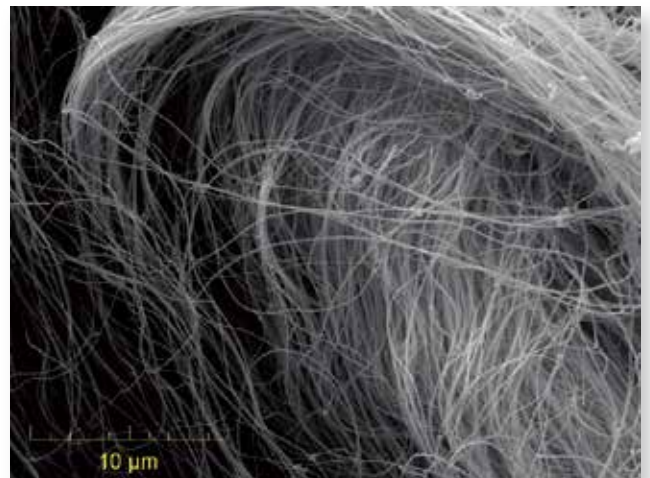
图4. 碳纳米管（CNTs）In-Beam探测器，景深模式，加速电压15kV，观察碳纳米线的形貌及方向性
