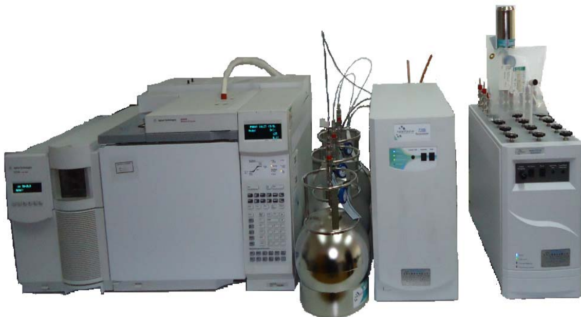
采样袋, 迷你罐自动进样器 7032A 与 7200 (7100A) 预浓缩仪联用示意图
