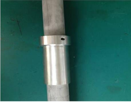
第五步：根据需要沉入的深度，把套筒移到合适的位置。
