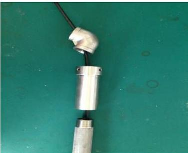
第三步：电极线穿过不锈钢管，固定套筒和弯头。固定套筒有台阶和螺钉孔一端在上面，如上图，不能颠倒，否则无法固定。一定要按此顺序。
