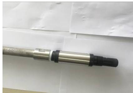
第四步：溶氧电极顶部螺纹与不锈钢管内螺纹拧紧。
