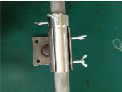
第七步：用螺钉固定不锈钢套筒在固定支架里。
