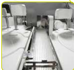
比色杯轨道可上载360个测试的比色杯，真正实现无人值守
