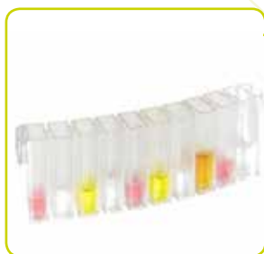
一次性分立式10联可弯曲比色杯，自动连续添加和去除
