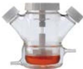
Celstir 夹套双侧臂细胞培养瓶可以通过配套恒温水浴设备对培养过程进行精确控温。夹套接口可以连接 1/4 in (6.35mm) 内径的软管。
