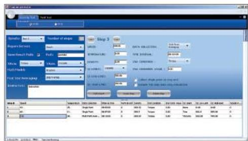
PG Flash软件允许用户创建可重复使用的自定义多步测试程序至DV2T中，可高达25个步骤。
