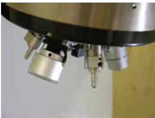
图2. 拆除掉防护罩的 转动塔近距离照片
