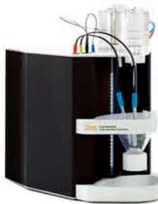
T-METAL 是一款高精度多样品多基质重金属分析仪器。可快速检测产生线性的结果，并带有后续处理程序。其检出限很低（通常低于 ppb），因此检测微量或痕量金属同样可以获得很高的准确度，重复性很高，可批量处理样品。与其他相似技术不同，T-METAL 可直接对原样品进行分析，这些基质无需进行化学或物理的前处理。而且在分析时不会破坏样品。这些优点使 T-METAL 特别适用于日常的分析，对非专业技能的使用者非常适用。由于仪器体积较小，故可实现高效的现场检测。相比于 AAS 或 ICP-AES 检测仪，T-METAL 重金属分析仪的采购成本要低得多，但是却可以进行相同甚至更加灵敏的重金属分析。是一款替代 AAS 和 ICP 检测仪的理想解决方案。目前在欧美正取代传统的原子吸收方法大量应用于环境应急监测、自来水检测、食品、制药、医院废水监测等方面，美国 EPA、欧盟委员会等权威机构已经将其列为标准检测方法，如 EPA7063 及 7472 等等。
