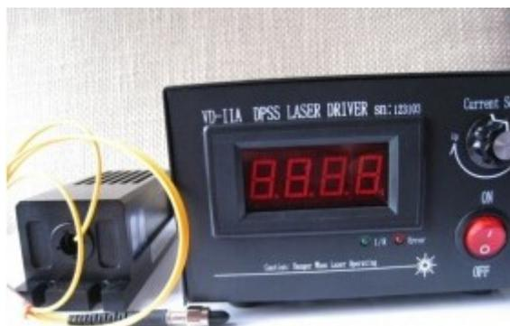
本模块包括：980nm 可调制激光器及托架，Syn0101 同步信号转换模块及相关线缆；
