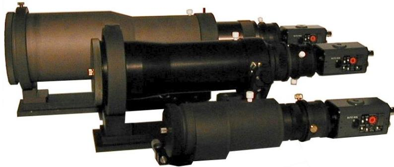
闭环自适应光学系统是用来纠正低阶激光光束产生的波前畸变。该系统是利用压电式变形镜作为波前校正器，利用 Shack-Hartman 波前传感器作为波前测量，闭环软件是用来控制整套校正系统。
