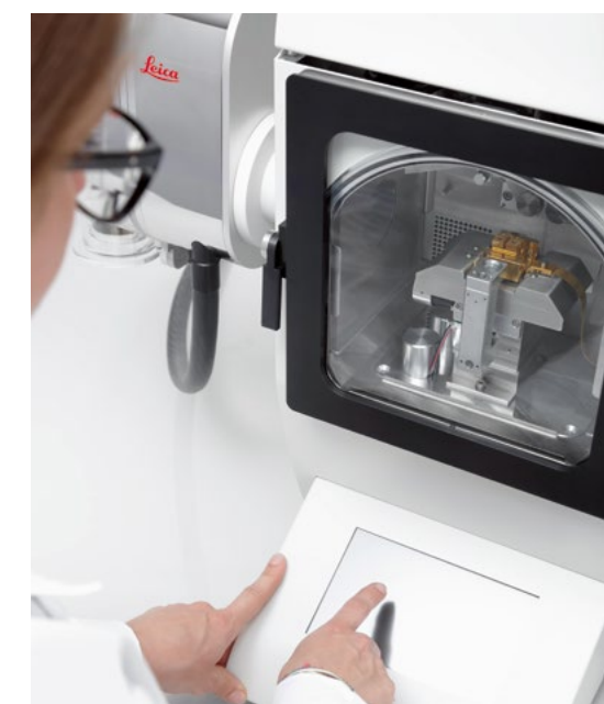
触摸屏操控带有Leica EM VCT100真空冷冻传输装置的EM ACE600
