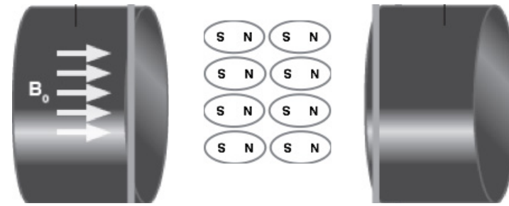
1_ 永磁铁提供固定的磁场方向
