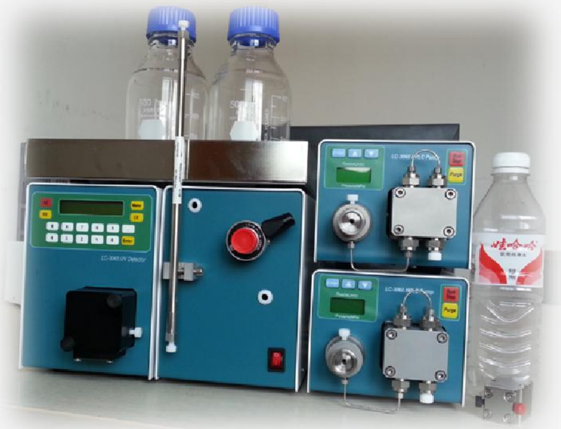
分体积木式液相色谱系统（该系统有常规分析型、高压半制备及制备型）
