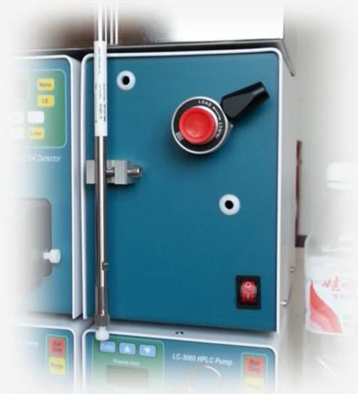
系统电源盒：含通讯、供电模块，可安装混合器、进样阀和色谱柱
